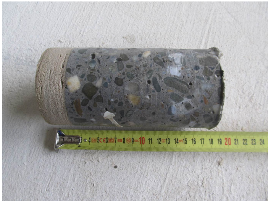
Foto 6 Odwier nr 2 (ściana części głębszej)
