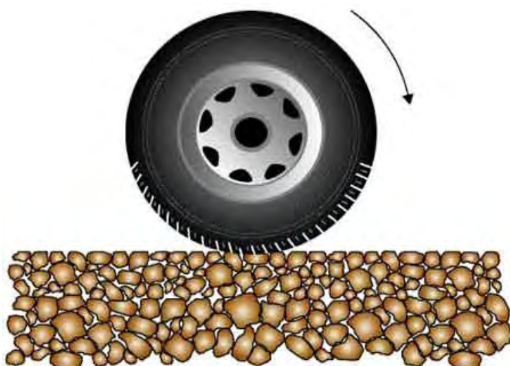
Rysunek 12-2 Asfalt porowaty o dużej zawartości próżni (źródło nynas.com)
