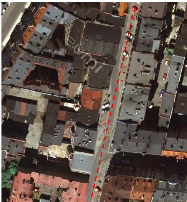
Rysunek 12-4 Wprowadzenie uspokojenia ruchu poprzez zmianę geometrii ulicy – pierwotny przebieg oznaczono kolorem czerwonym – Katowice (źródło: materiały własne).
