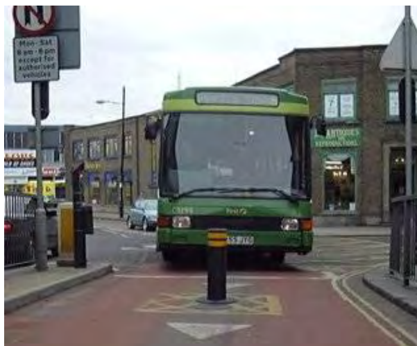
Rysunek 12-19 Automatyczny, „inteligentny” słupek przepuszczający tylko np. autobusy komunikacji miejskiej (źródło: materiały własne).
