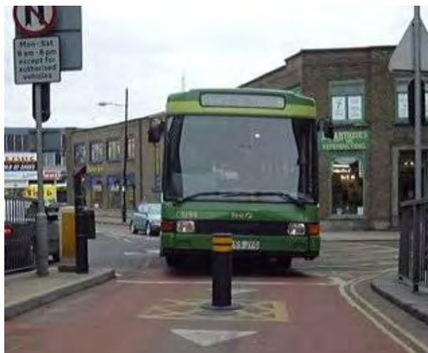
Rysunek 12-19 Automatyczny, „inteligentny” słupki przepuszczający tylko np. autobusy komunikacji miejskiej (źródło: materiały własne).
