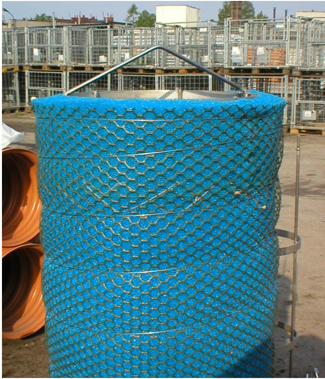
Rysunek 5. Filtr separatora oleju PEK filter w czasie konserwacji
